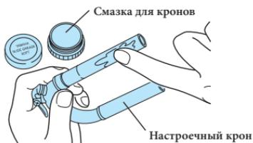
2. Подвигайте вперёд назад настроечный крон несколько раз, чтобы равномерно распределить смазку.
