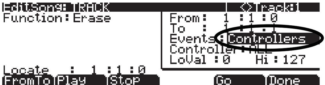
6. Установите параметр **Controller** в значение **Volume**. Эту операцию можно выполнить быстрее, выбрав поле **Controller**, нажав **7** на буквенно-цифровой панели, и затем нажав кнопку **Enter**. Убедитесь, что параметр **LoVal** установлен на **0**, а параметр **Hi** установлен на **127** (см. ниже).
