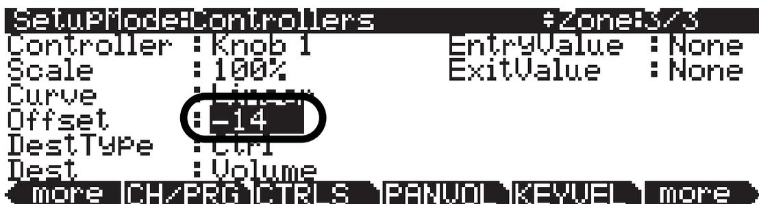
Теперь с помощью регулятора 1 (отмеченного Mod на передней панели) вы сможете управлять уровнем громкости пэдов в зоне 2 и 3 (в противном случае, вернитесь к предыдущим шагам). Значение Zone 3 всегда будет на 14 MIDI шагов ниже, чем значение Zone 2, благодаря установленному параметру смещения.
