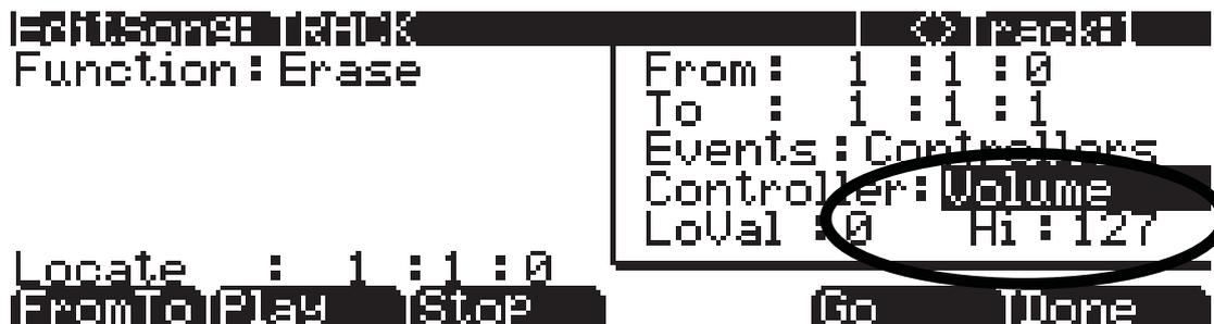
7. С помощью параметров **From** и **To** настройте диапазон времени, в котором вы хотите удалить автоматизацию громкости. Вы можете воспроизвести песню и в поле **Locate** определить эти временные значения. Например, допустим вы хотите удалить автоматизацию громкости в такте 3 (см. ниже).
