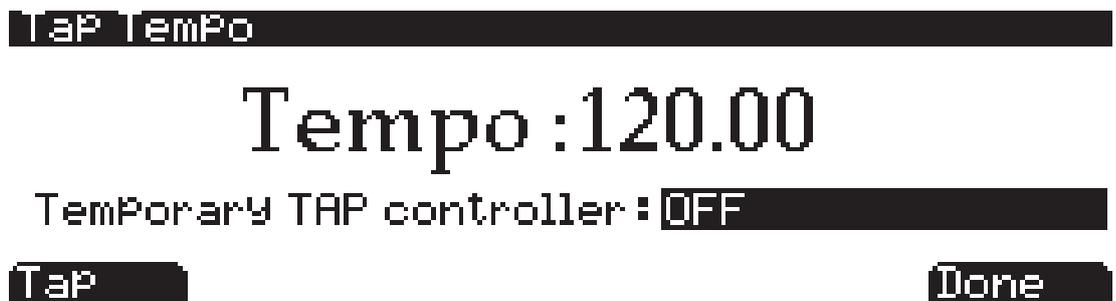
Также вы можете настроить контроллер для использования в поле временного контроллера TAP, или воспользоваться программной кнопкой **Tap**. Временные контроллеры TAP функционируют только на странице Tap Tempo и могут быть выбраны при переходе к экрану Tap Tempo из других режимов, но при последующем включении PC3LE они будут переключаться на OFF.
